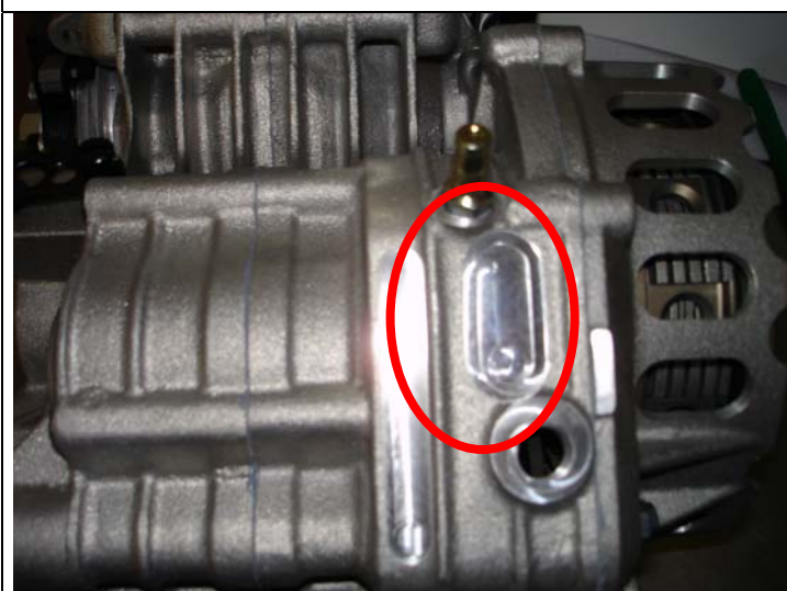
POSITIONNEMENT CARTER LOCATION ON THE ENGINE SUMP
