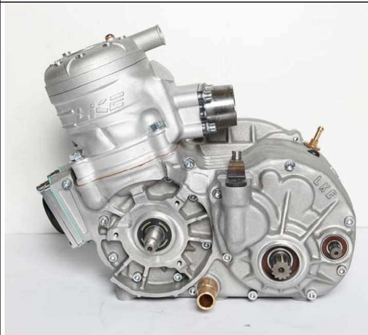
PHOTO DU MOTEUR CÔTÉ PIGNON PHOTO OF DRIVE SIDE OF ENGINE
