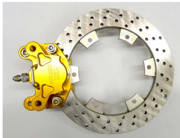
Photo du frein arrière : étrier(s) et disque(s) seulement Photo of rear brake: caliper(s) and disc(s) only
