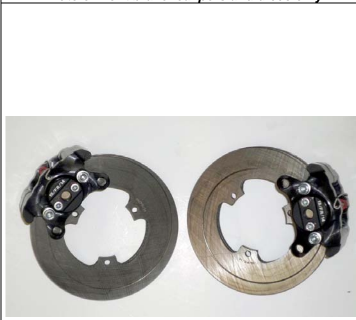
Photo du frein avant : étriers et disques seulement Photo of front brake: calipers and discs only
