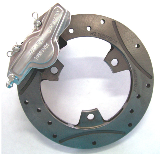
Photo du frein avant : étriers et disques seulement Photo of front brake: calipers and discs only
