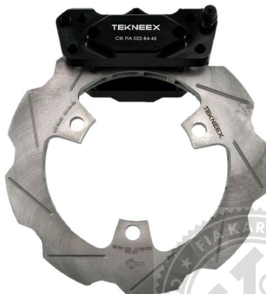
Photo du frein arrière : étrier(s) et disque(s) seulement Photo of rear brake: caliper(s) and disc(s) only
