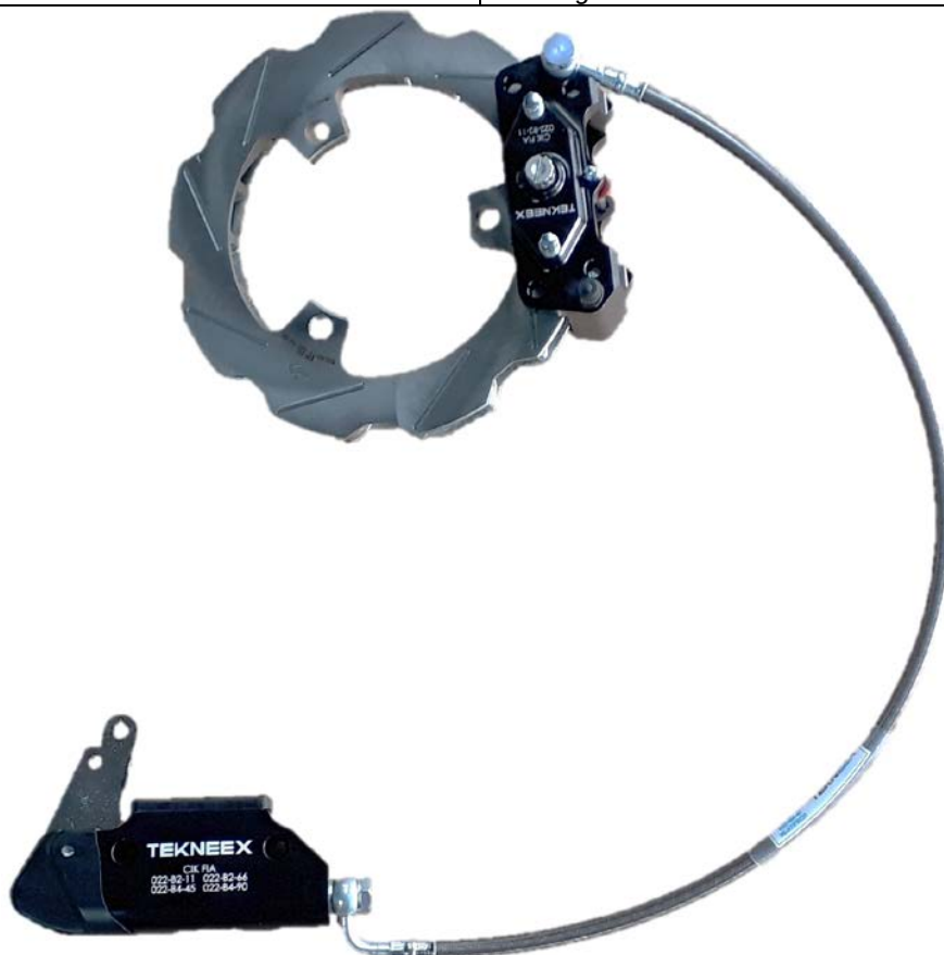
PHOTO VUE DE DESSUS DU SYSTÈME COMPLET
