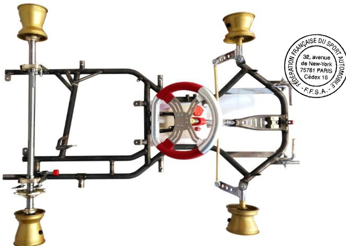
**PHOTO DU CHASSIS COMPLET (sans pneu).**
