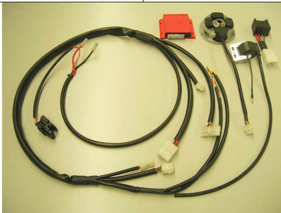
PHOTO de l'ensemble rotor, stator, bobine, boîtier électronique et cablage complet
